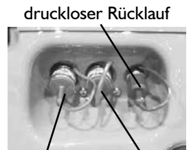
druckloser Rücklauf Druckleitung 1 Druckleitung 2
